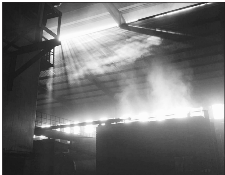
宁夏绿源恒活性炭有限责任公司炭化炉车间无组织排放严重。
