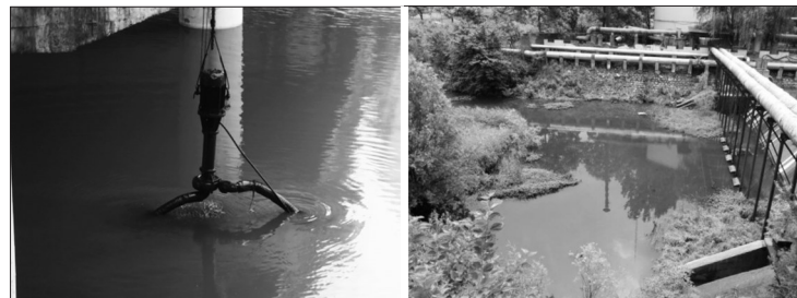
企业设置潜污泵,废水直排严重影响金水河水水质。
