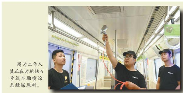
因为工作人员正在为地铁6号线车厢喷涂光触媒原料。
