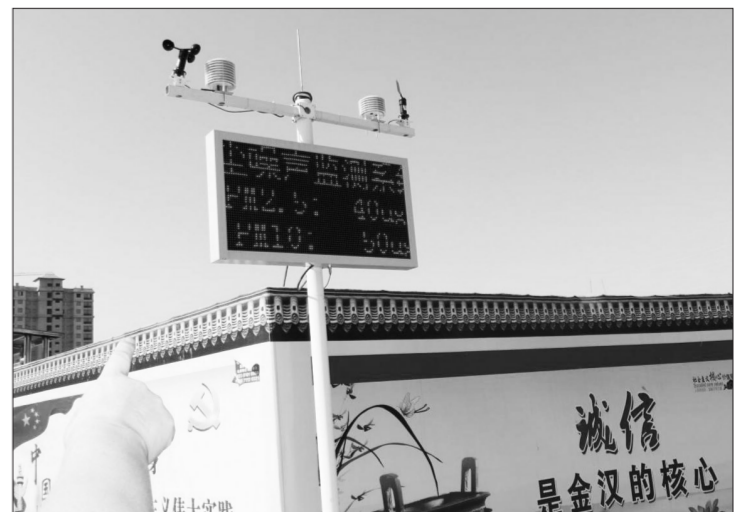
河南省周口市积极推进工地扬尘管控“数字化”管理,要求市内所有工地在“6个100%”基础上,实现“数字化”管理百分之百。旨在通过在线监测和视频监控设备,实现360度全方位、24小时实时监控工地绿色生产、运输及扬尘情况,及时发现问题并协调相关部门处置,有效加强工地扬尘管控。罗景山摄
