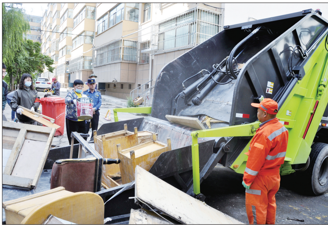
9月1日,在青海省西宁市城西区中华二巷,一辆黄绿相间的大型垃圾压缩车正在作业。伴随着一阵嘎吱嘎吱的声音,垃圾车很快将废旧家具压缩成片状或块状垃圾。这是西宁市首辆新型的大件垃圾破碎压缩车,可处理沙发、椅子、桌板等大件木质家具,一趟可收运垃圾12吨。居民可通过社区登记预约在各小区、楼院集中处理大件垃圾。 人民图片网供图
