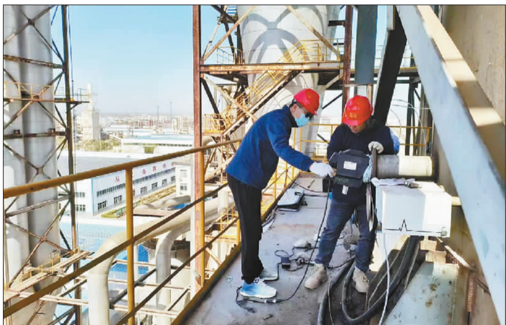
山东省济宁生态环境监测中心秉持求真务实工作作风,狠抓监测质量、监测能力和数字智能三个提升,为环境管理提供准确、可靠的监测数据。图为工作人员在企业现场开展污染源废气比对监测。 李英德 虎玉建 冯培坤摄影报道
