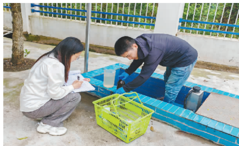
为确保汛期水环境安全,近日,四川省广元市苍溪县生态环境局开展污水处理设施专项检查,对全县31座污水处理厂设施运维、进出水质、污泥处置、运行台账等情况进行了全面检查;同时,坚持执法与帮扶相结合的原则,对存在的问题提出整改要求,督促企业按时完成整改任务。图为生态环境监测人员对污水处理厂出水水质进行采样检测。向文供图
